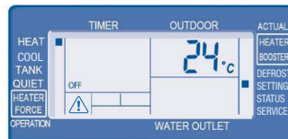
5. Solltemperatur zum Abschalten des Heizbetriebs (Heizgrenztem- peratur, 5 bis 35 °C, Std. 24 °C)
