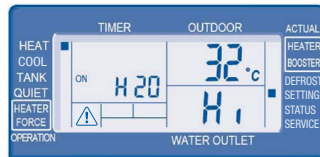
4. Wasseraustritts-Solltemperatur für Heizbetrieb bei hoher Außentem- peratur (25 bis 55 °C, Std. 32 °C)
