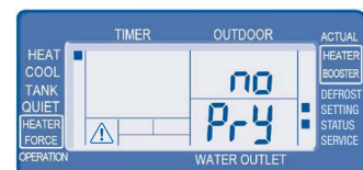
6. Heizungsvorrang (YES/NO, Standard: NO) Dieser Wert sollte möglichst auf NO stehen bleiben, weil ansonsten Warmwasser nur mit dem E-Heizstab aufgeheizt wird.
