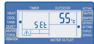
8. Solltemperatur des Warmwasser- speichers (40 bis 75 °C, Std. +55 °C)
