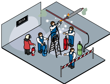
Standardmontage mit Brandschutzvorkehrung
